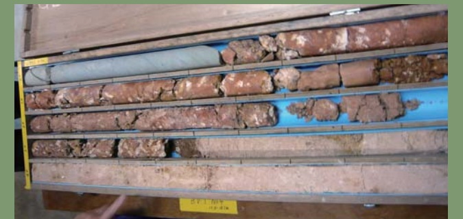
バイヨン寺院の基壇部のボーリングによりサンプルを採取 表層から砂岩(写真左上の灰色部分)、ラテライト(赤茶色の部分)、版築土
